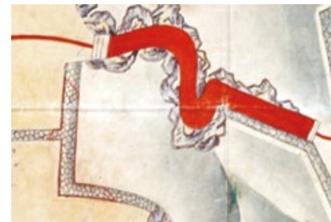
紀州新宮城絵図に描かれた石垣破損場所 (破損部分が朱線で囲まれている)
